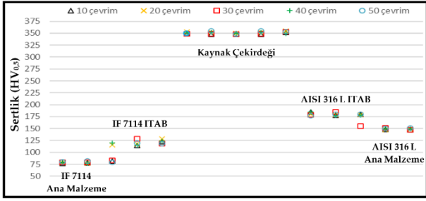
Şekil 11: 6 kN elektrod kuvveti ve 3 kA kaynak akımında birleştirilmiş numunelerin sertlik grafiği.
