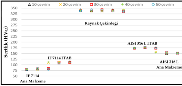
Şekil 10: 3 kN elektrod kuvveti ve 9 kA kaynak akımında birleştirilmiş numunelerin sertlik grafiği.
