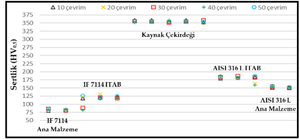
Şekil 14: 6 kN elektrod kuvveti ve 9 kA kaynak akımında birleştirilmiş numunelerin sertlik grafiği.
