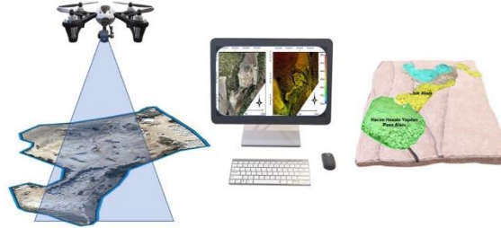
Figure. İHA fotogrametrisi ile üretilen dijital çıktılardan hacim hesabı (Volume calculation from digital outputs produced by UAV photogrammetry)
