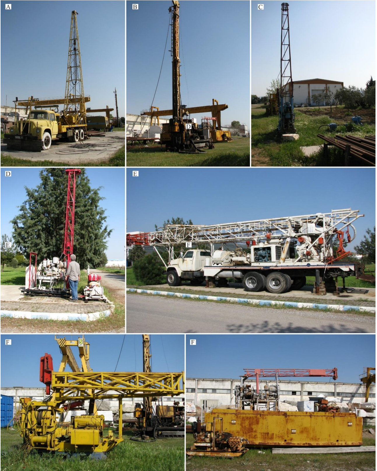
Şekil 4. DEÜ-TMY Sondaj Teknolojisi Programı Su, Zemin Ve Maden Sondajı Makinaları. A: 600 M Kapasiteli Failing 1500 Marka Su Sondaj Makinası. B: 1500 M Kapasiteli Sonmak Marka (Levent 3003) Maden Sondaj Makinası. C: 150 M Kapasiteli D500 Marka Zemin Sondaj Makinası. D: 150 M Kapasiteli Longyear Marka Zemin Sondaj Makinası. E: 1500 M Kapasiteli GMC Marka Su Sondaj Makinası. F: 500 M Kapasiteli Longyear Marka Zemin-Maden Sondaj Makinası. F: Sığ Deniz Sondajları İçin 16 m 2 Yüzey Alanına Sahip Duba Ve 150 M Kapasiteli Longyear Marka Zemin Sondaj Makinası (DEU-TMY Drilling Technology Program Water, Soil And Mine Drilling Machines. A: Failing 1500 Brand Water Drilling Machine With 600 M Capacity. B: Sonmak Brand (Levent 3003) Mining Drilling Machine With A Capacity Of 1500 M. C: D500 Brand Soil Drilling Machine With 150 M Capacity. D: Longyear Brand Soil Drilling Machine With 150 M Capacity. E: 1500 M Capacity GMC Brand Water Drilling Machine. F: Longyear)
