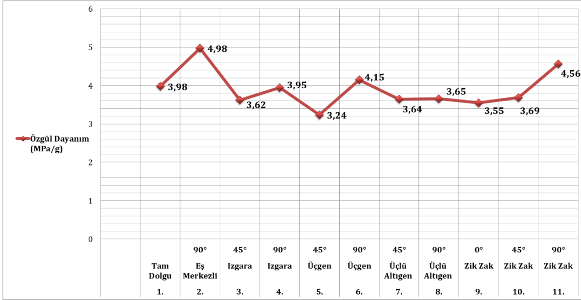
Şekil 7. Numunelerin özgül dayanımlarının karşılaştırılması (Comparison of specific strengths of specimens)
