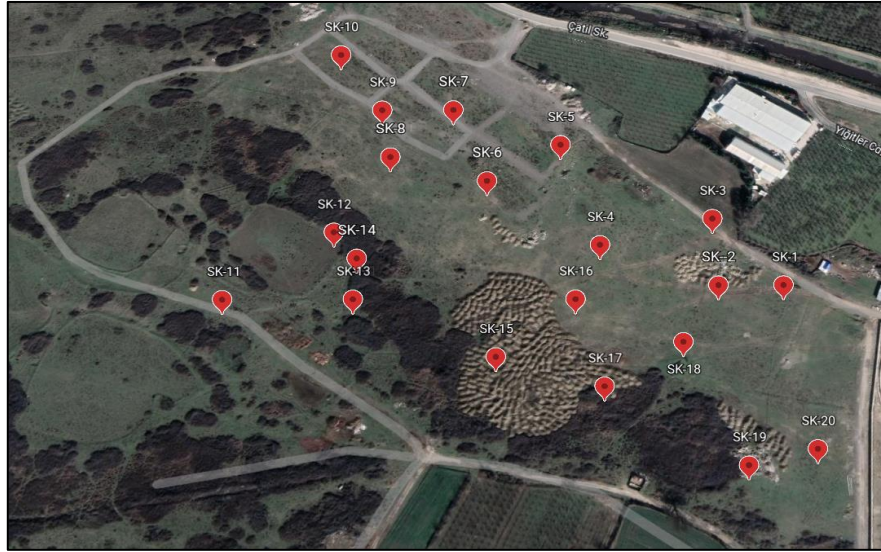
Şekil 2. Sondaj yerleşim planı (Borehole location plan)
