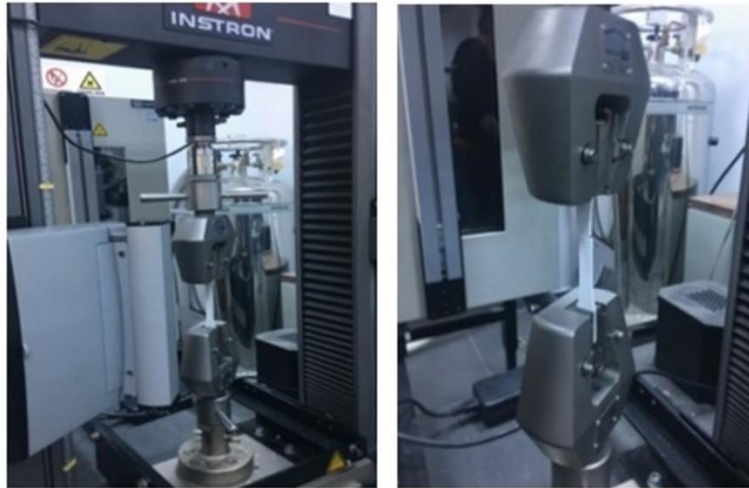
Şekil 4. Çekme testinin numunelere uygulanışı (Application of the tensile test to specimens)
