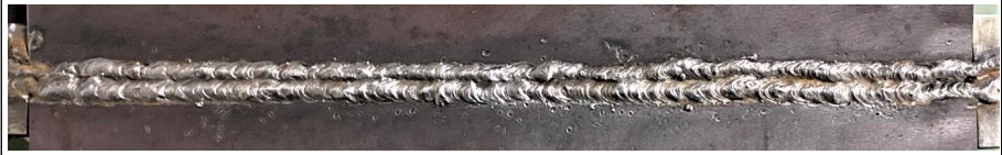
Şekil 2. Su Altında Kaynatılan 400 mm Uzunluğundaki Plakanın Kaynak Dikiş Görüntüsü
