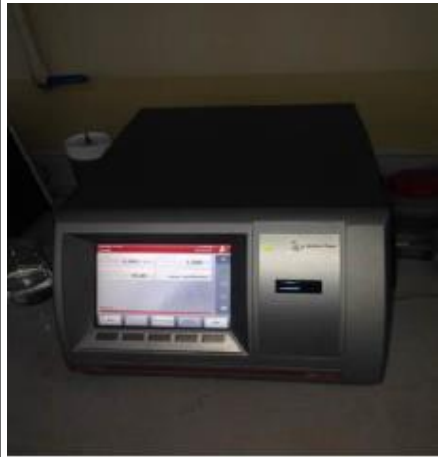
Şekil 3. Anton-Paar DMA 4200 Yoğunluk ölçer cihazı (Karabulut, 2015)
