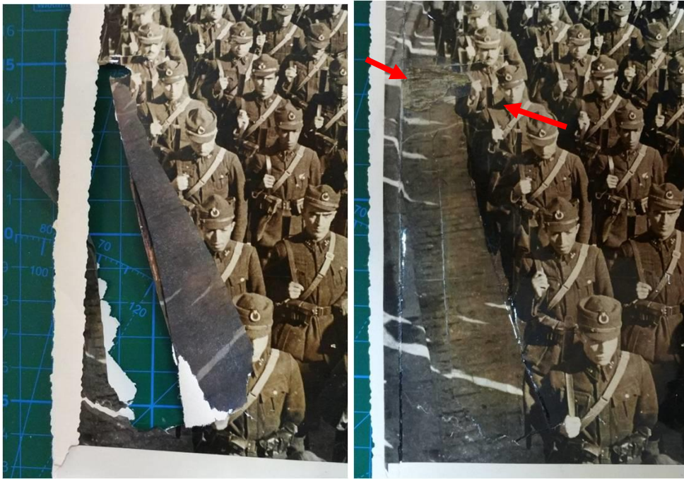
Şekil 6. Duyarkat Tabakası Fotoğraf Kâğıdı Zemininden Ayrılarak Parçalanmış Bir Fotoğrafın Restorasyon Öncesi Durumu (Sol), Filmoplast P, P90 ve PVA ile Onarım Sonrası Görüntüsü (Sağ).
