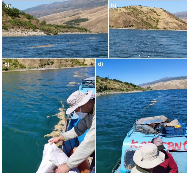
Şekil 6. Doğançayol kuzeyinde Karakaya Baraj Gölü'nde suyun sakin olduğu dönemde su üzerine farklı alanlara saman (a, c, d) ve köpük (strafor parçası) (b) bırakılmıştır. Suyun sakin olduğu dönemde su üzerindeki parçaların düzensiz bir dağılım sergilediği dikkati çekmektedir.
