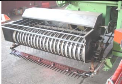
Şekil 2. Prototip hasat-harman makinasının biçme ve pikap düzeni
