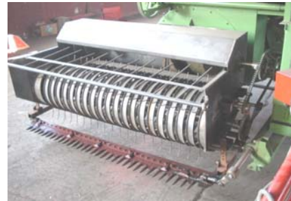
Şekil 2. Prototip hasat-harman makinasının biçme ve pikap düzeni
