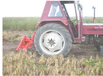
Şekil 8. Çift bıçaklı çayır biçme makinası ile fasulye hasadı
