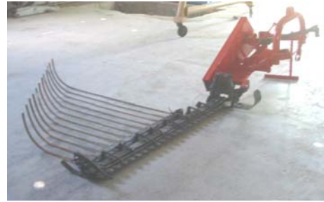
Şekil 1. Çift bıçaklı çayır biçme makinasının ve ilave edilen namlu düzeninin genel görünüşü
