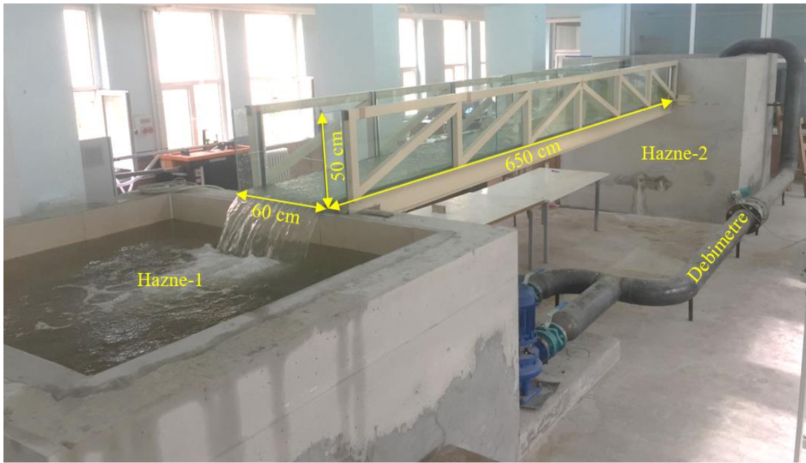
Şekil 7. Deneylerde kullanılan açık kanal düzeneği Figure 7. Open channel system used in experiments
