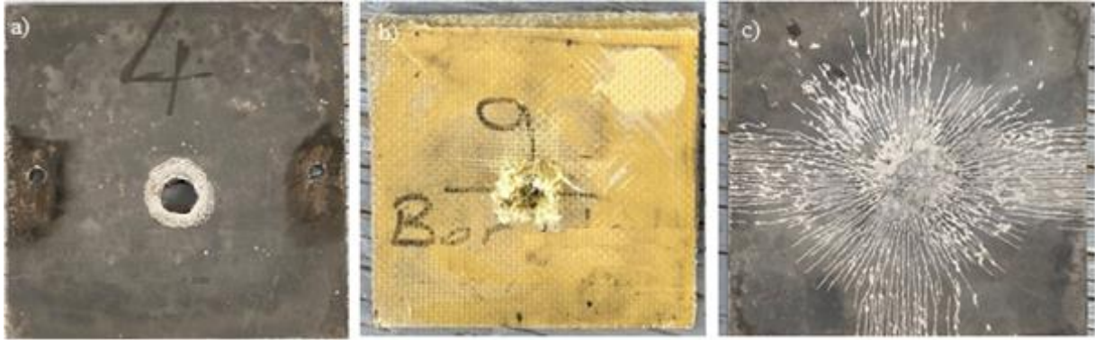
Şekil 7. ZM-4 zırh modelinde atış sonrası oluşan hasar görüntüleri a) borlanmış çelik (B) b) çift katman kevlar plaka (K+K) c) borlanmış çelik (B).
