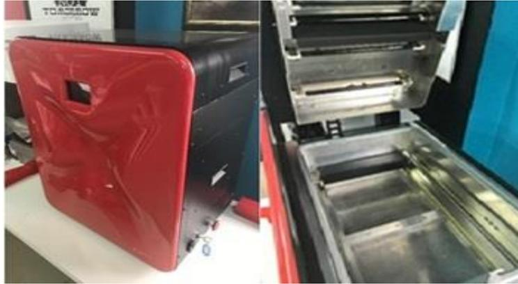
Figure 4. Sinterit lisa brand printer and production area used in SLS method (SLS yönteminde kullanılan Sinterit lisa marka yazıcı ve üretim alanı)
