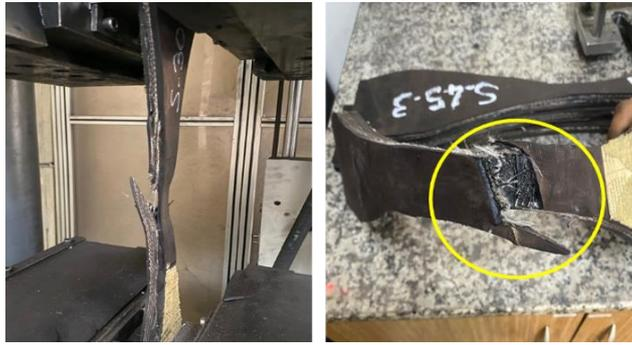
Figure 14. Breaking of specimen number S-30-3 after tensile test (S-30-3 numunesinin çekme testinden sonra kırılması).
