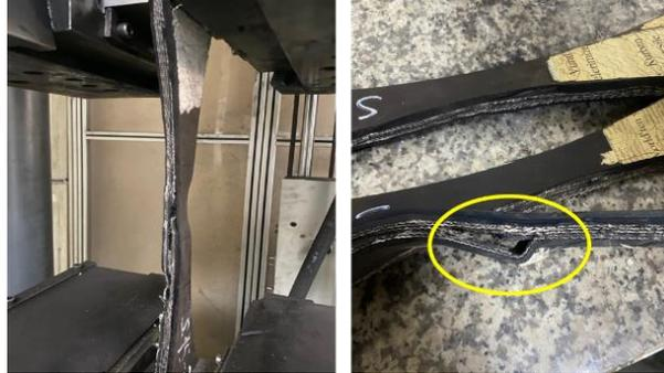
Figure 12. Breaking of specimen S-15-3 after tensile test (S-15-3 numunesinin çekme testinden sonra kırılması).
