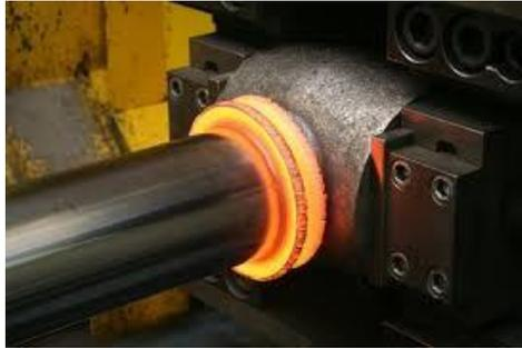
Figure 4. The yoke shaft during CDFW operation (CDFW işlemi sırasında çatalı mil)
