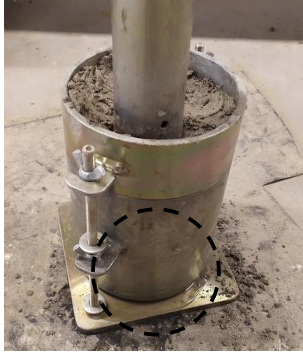
Şekil 3. Kalıp tabanında serbest su gözlemlenmesi
