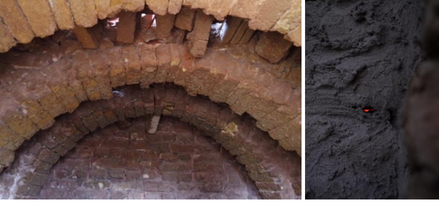
Fotoğraf 13: Fırın içindeki ızgara yapı ve fırının dışındaki gözetleme deliği(fırın içindeki çömlerlerin pişirim esnasındaki akkor halleri görünmektedir).
