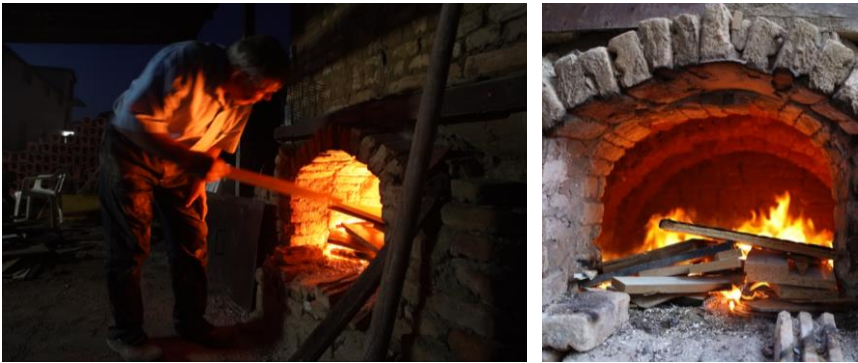
Fotoğraf 15: Salih Usta fırını odun ile beslerken ve fırının yanma bölümünden bir fotoğraf.
