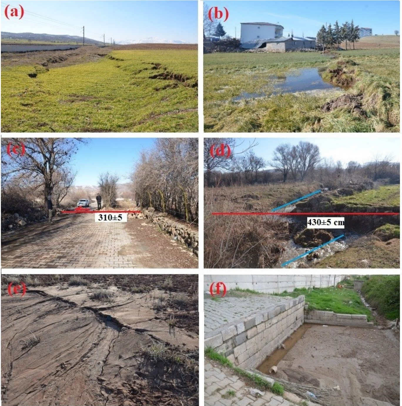
Fotoğraf 1. Çalışma sahasında meydana gelen yüzey deformasyonları: Balkar ve İnekli Gölü arasındaki küçük çek-ayır havza (a), Balkar'da tektonik çöküntü gölcüğü (b), Depremler nedeniyle yolda (c) ve dere yatağında (d) meydana gelen ötelenmeler, Aşağıazaplı köyünde kurumuş çeşme (e) ve Gölbaşı'nda oluşan kum püskürmesi (f).
