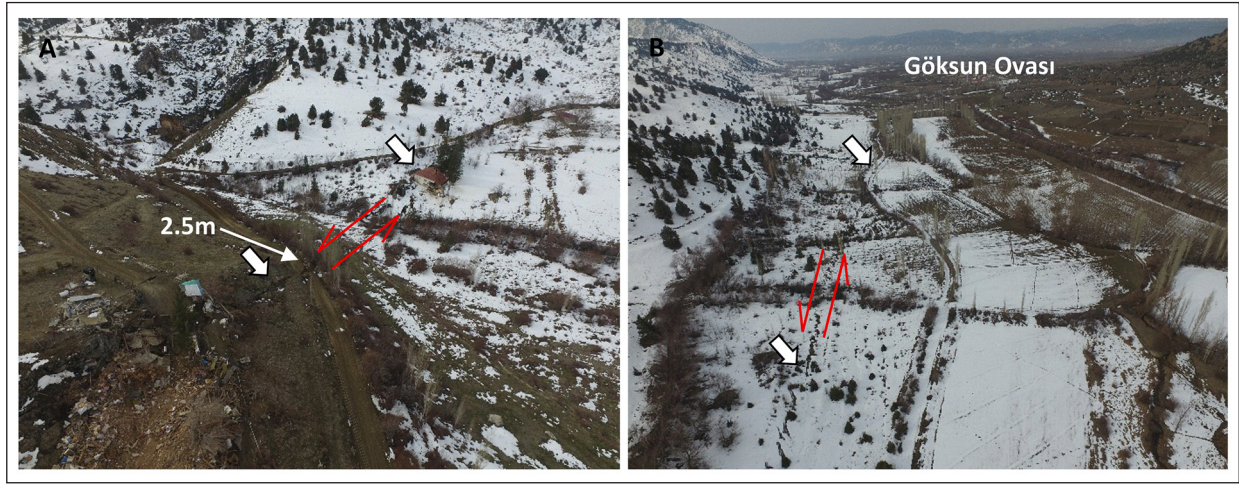
Şekil 11. Saraycık güneyinde arazide gözlemlenen 2.5\pm 1 metrelik atım (A) ile yüzey kırığının Karahmet güneyinde Göksun Ovasına girdiği kısım (B).
