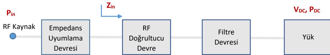
Şekil 1. Doğrultucu devrenin şematik gösterimi
