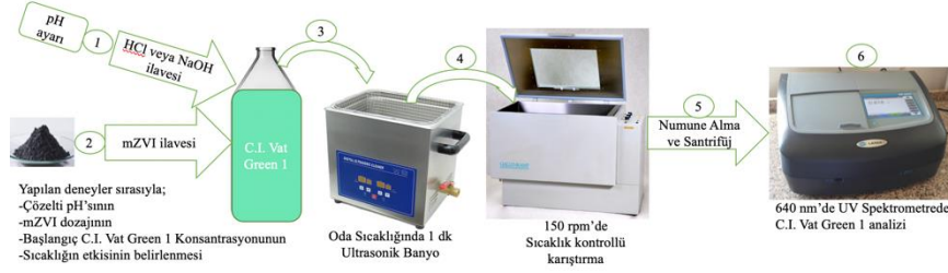
Şekil 2. Deney aşamalarının şematik gösterimi (işlem basamakları sırası ile numaralandırılmıştır)
