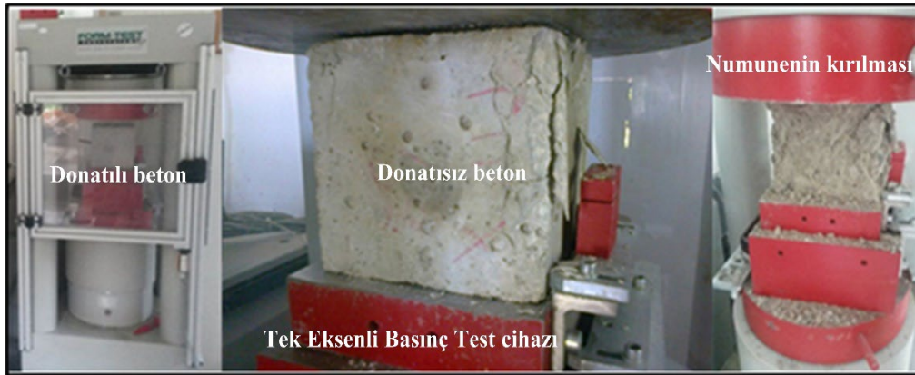
Şekil 3: Tek eksenli basınç dayanımı test cihazı ile beton dayanımının belirlenmesi Figure 3: Determination of concrete strength with a uniaxial compressive strength test device
