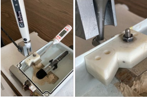
Resim 1. Şekildeki görselde kullanılan statik döngüsel yorgunluk düzeneği izlenmektedir.
