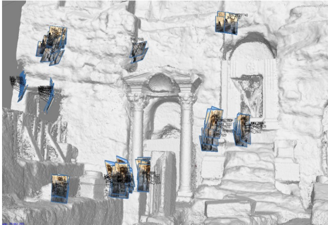
Şekil 6. Fotogrametri için fotoğraf çekme açıları ve sistemi.
