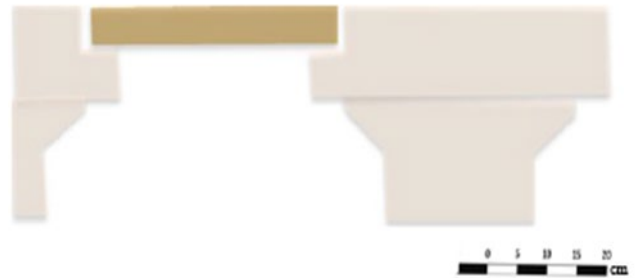
Şekil 20. Alt kat anakaya kesme taş döşeme detayı analitik çizimi.
