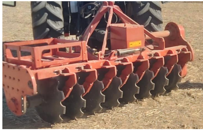
Şekil 1. Kuyruk Milinden Hareketli Tek Etkili Diskli Tırmık Figure 1. PTO Driven Single Acting Disc Harrow
