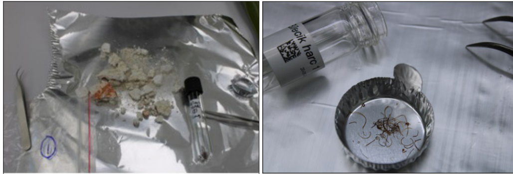
Resim10: Örneklem Yapılan Harç Numunesi (a), Fiziksel ve Kimyasal Temizlik İşlemi Tamamlanmış Örneklem (b).
