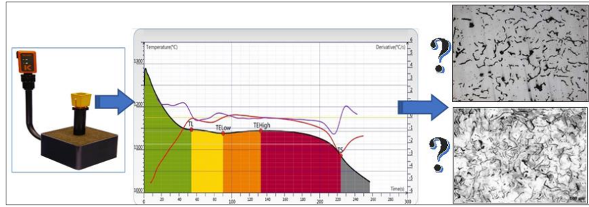
Figure A: Use of thermal analysis for structural prefixing in cast irons / Şekil A: Dökme demirlerde yapısal ön tespit yapılması için termal analizin kullanımı
