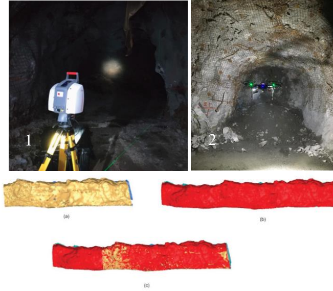
Şekil 6. Yersel lazer tarayıcı (1) ve İHA (2) ile 3 boyutta galeri oluşturma [25,27].
