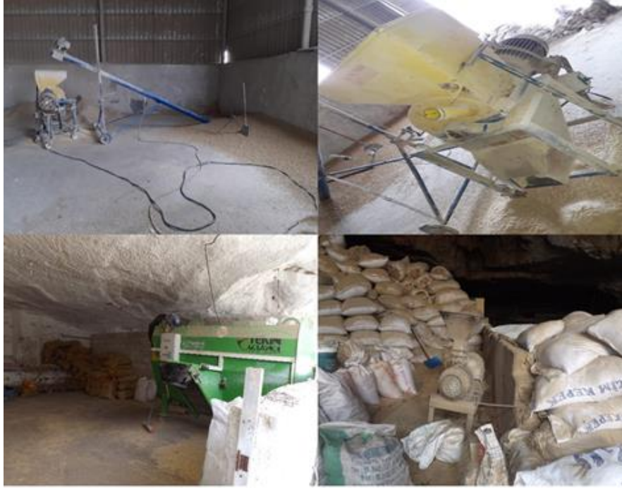
Şekil.4. Eyyubiye ilçesinde kesif yem üretimi için kullanılan hububat ezme, kırma ve karma yem makineleri.
