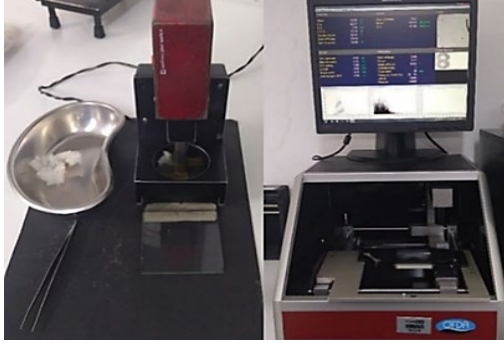
Resim 3: Testlerde kullanılan OFDA elyaf incelik test cihazı
