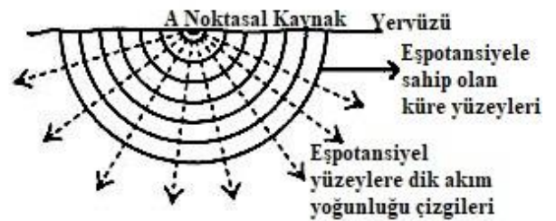
Şekil 2: Akım yoğunluğunun homojen bir toprakta dağılımı [20]
