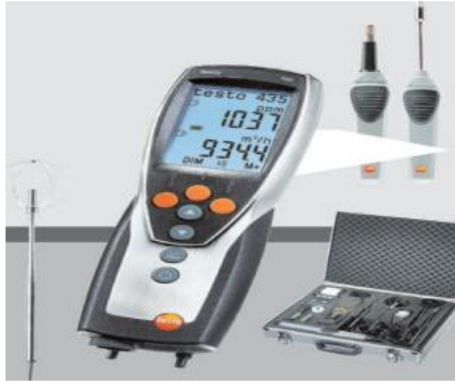
Şekil 11. Çoklu ölçüm cihazı (CO 2 , CO, hava hızı, sıcaklık, nem, mutlak basınç, ışık şiddeti, U-değeri)
