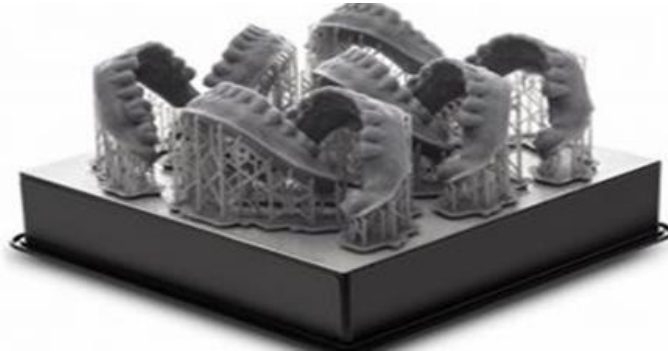
Şekil 14. Katmanlı imalat yöntemiyle üretilmiş diş-çene iskeleti (Özer vd., 2020)
