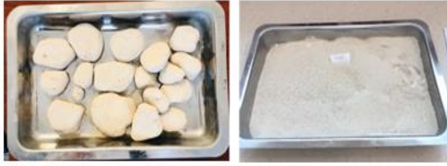
Şekil 2. Trakitik tuf kayaç parçaları ve öğütülmüş trakitik tuf Figure 2. Trachytic tuff rock fragments and ground trachytic tuff
