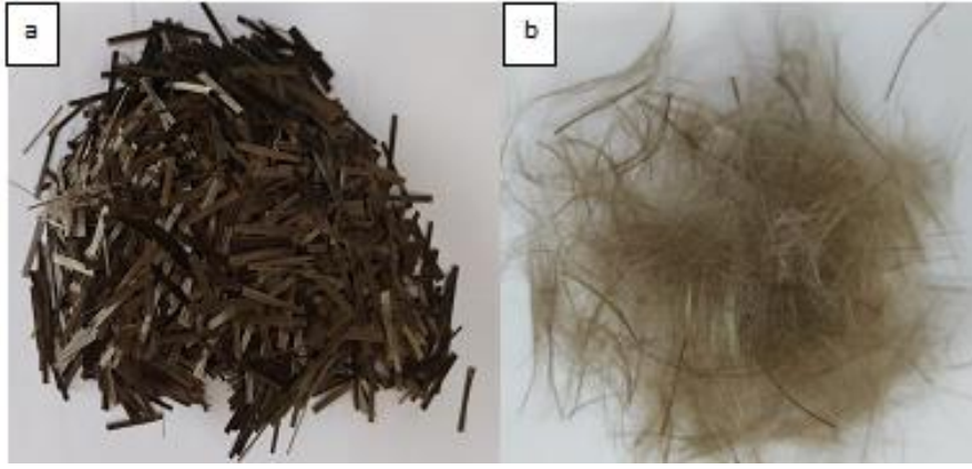
Şekil 2. Çalışmada kullanılan ayrıştırılmamış (a) ve ayrıştırılmış (b) bazalt fiberler Figure 2. Unseparated (a) and separated (b) basalt fibers used in the study
