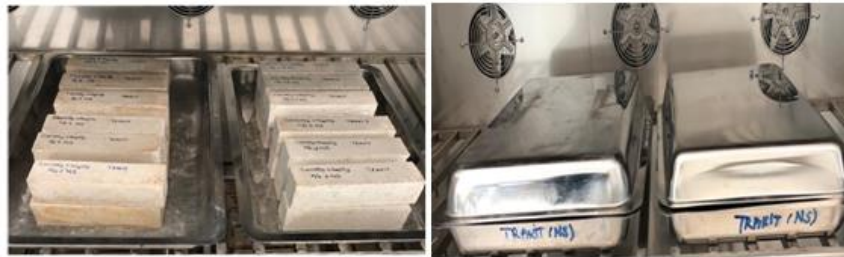
Şekil 4. Geopolimer harçların etüv kürü Figure 4. Oven curing of geopolimer mortars
