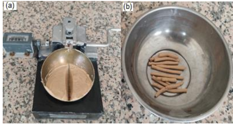
Şekil 4. Likit (a) ve plastik (b) limit deneyleri
