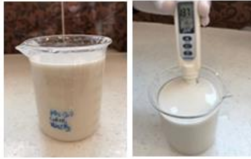
Şekil 3. Kombine alkali aktivatörün pH'ı Figure 3. pH of the combined alkaline activator
