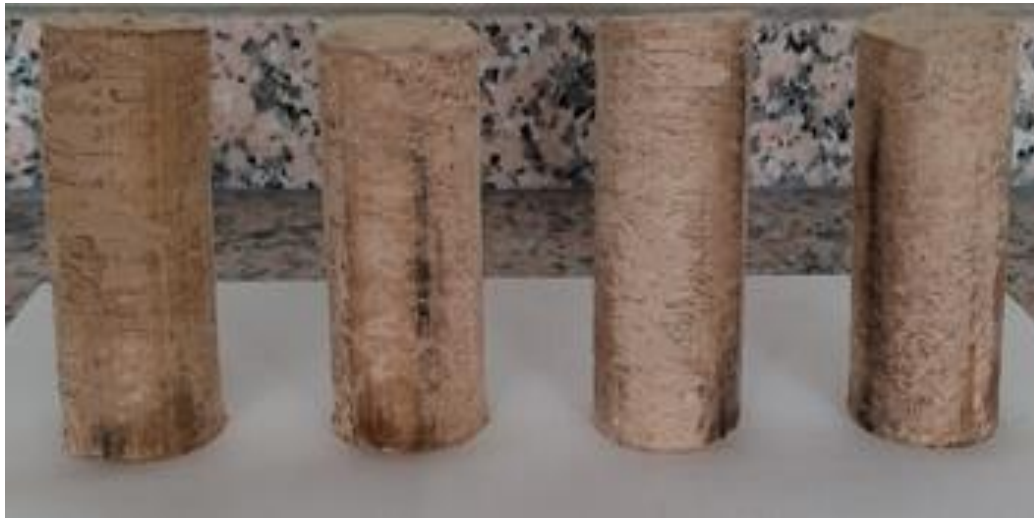
Şekil 6. Serbest basınç deneyi için hazırlanmış bazalt fiber katkılı silindirik örnekler
