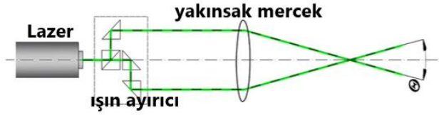
Şekil 3. Doppler rüzgâr LIDAR'ı çalışma prensibi
