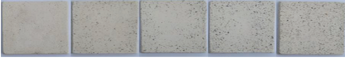
Görsel 11. Alüminyum Atığı Katkılı Pişmiş Stoneware Plakalar (Soldan Sağa Katkı Oranları: %0, %1, %3, %5, %7)
