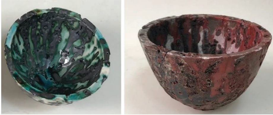
Görsel 15. Bakır Metali Katkılı Çanağın Nötr Fırın Atmosferinde (Solda) ve İndirgen Fırın Atmosferinde Pişmiş Görselleri (Sağda)
