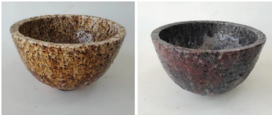
Görsel 19. Demir Talaşı Katkılı Çanağın Nötr Fırın Atmosferinde (Solda) ve İndirgen Fırın Atmosferinde Pişmiş Görselleri (Sağda)
