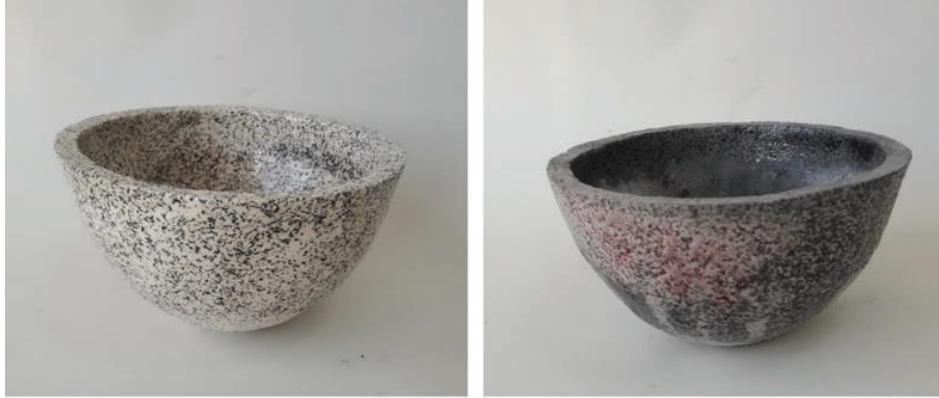
Görsel 20. Alüminyum Talaşı Katkılı Çanağın Nötr Fırın Atmosferinde (Solda) ve İndirgen Fırın Atmosferinde Pişmiş Görselleri (Sağda)
