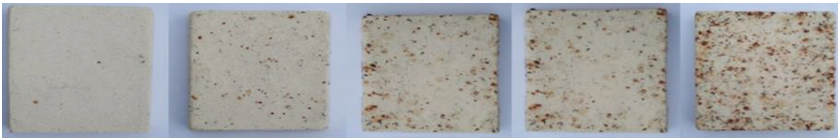
Görsel 10. Bakır Atığı Katkılı Pişmiş Stoneware Plakalar (Soldan Sağa Katkı Oranları: %0, %1, %3, %5, %7)
