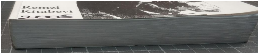
Şekil 8. Sırt yapıştırıcı tabakası tahrip olmuş karton kapak bir kitabın etek kenarı görüntüleri: a) Onarım öncesi kitabın açılı formdaki durumu b) Onarım öncesi kitabın dik hale getirilmeye çalışılmış formu c) Cilt ve tüm yaprakların yapıştırıcıdan ayrılmış hali d) Onarım sonrası kitabın son durumu.
