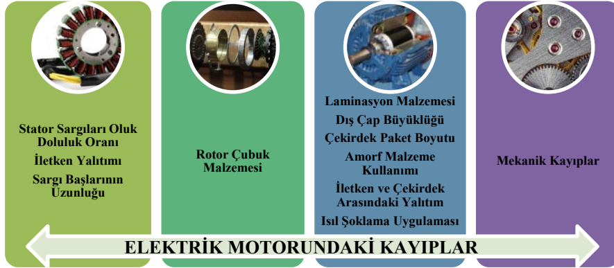
Şekil 5. Elektrik Motorlarındaki Kayıplar
