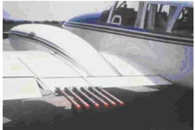
Şekil 5. Uçak kanatlarına yerleştirilmiş gümüş iyodür fişekleri
