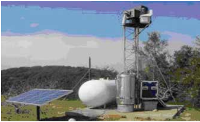
Şekil 7. Yüzeyden orografik bulut tohumlamada sistem unsurları
