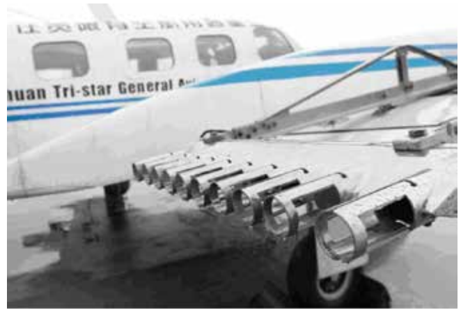
Şekil 4. Uçaklarda kanatlardan gümüş iyodür dumanı salan brülörler
