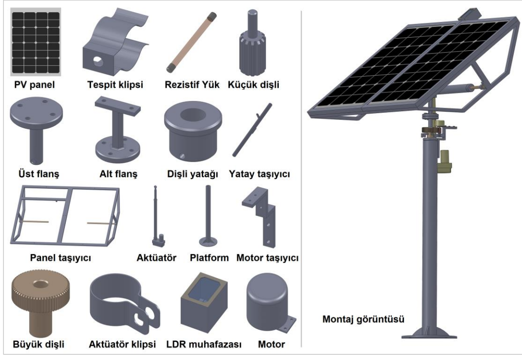
Şekil 5. Güneş izleyici sistemin 3D katı modeli.
