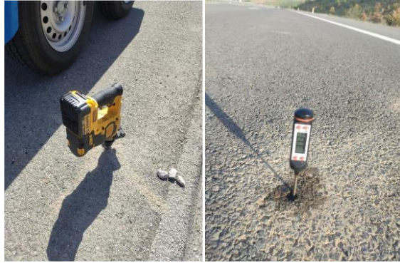
Şekil 8. Asfalt Sıcaklığının Tespiti
