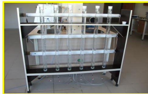
Şekil 2. Fotobiyoreaktör sistem elemanlarının birleştirilmiş halinin görünümü
