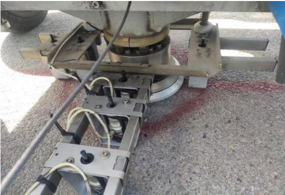
Şekil 9. Defleksiyon Sensörlerinin Ölçüm Noktalarına Yerleştirilmesi
