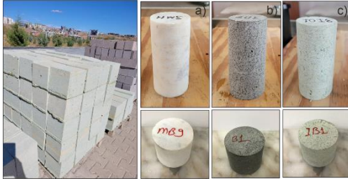
Şekil 1. Blok kayalar ve bunlardan hazırlanan karot ve disk şeklindeki örnekler (a) mermer (b) diyabaz (c) ignimbirit.
