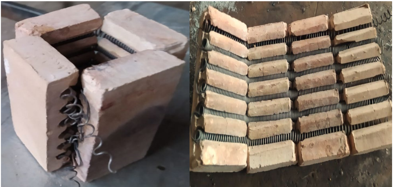
Şekil 2.1. Kanallı fırın taşı ve Nikrom direnç teli
