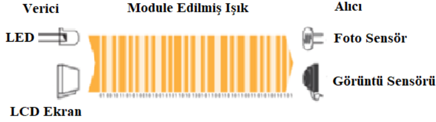
Şekil 1. Bir görünür ışık haberleşme sisteminin şeması [9]
