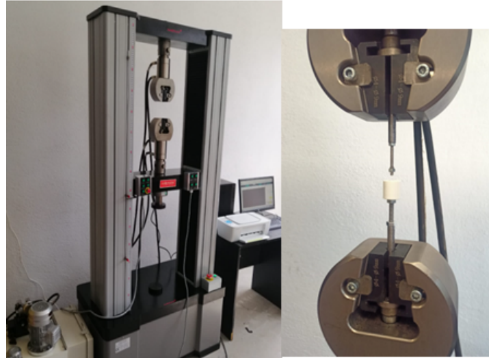
Şekil 5. Numunelere ait vida tutma kuvvetlerinin ölçülmesi (Measuring the screw pull out forces of the samples)
