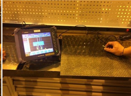
Şekil 19: Basamak şeklinde açma yöntemi ile yapılan tamire uygulanan darbe yankı metodu ile muayeneye ait görüntü
