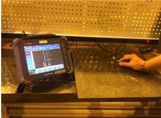
Şekil 18: Basamak şeklinde açma yöntemi ile yapılan tamire uygulanan darbe yankı metodu ile muayeneye ait görüntü
