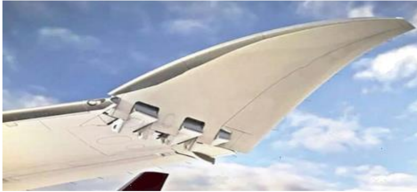
Şekil 8. Boeing 777x Katlanabilir Kanat Yapısı
