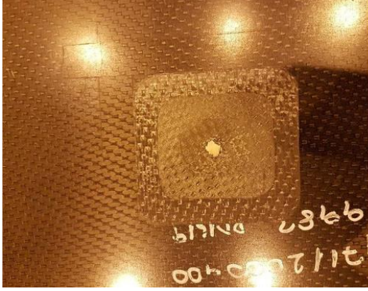
Şekil 14: Basamak şeklinde açma yönteminin arka yüzeyden açılma görüntüsü
