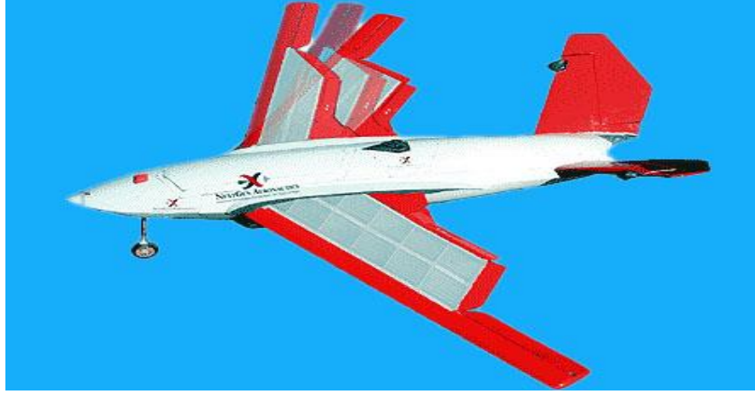
Şekil 20. NextGen Firmasının "Değişken Aç, Değişken Viter" Konsepti
