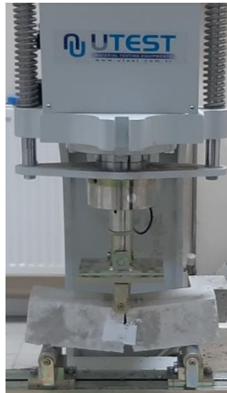
Şekil 4. Tek noktalı eğilme deneyi
