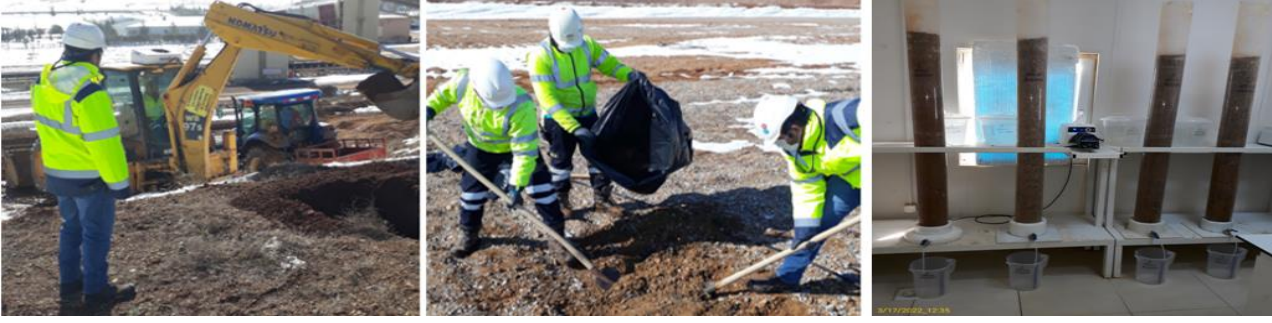
Şekil 2. Numunelerin Alınması ve Kolonların Hazırlanması
