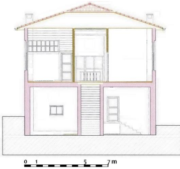
Çizim 9: Burhaniye İbtidai (Sıbyan) Mektebi doğu-batı röleve kesiti
