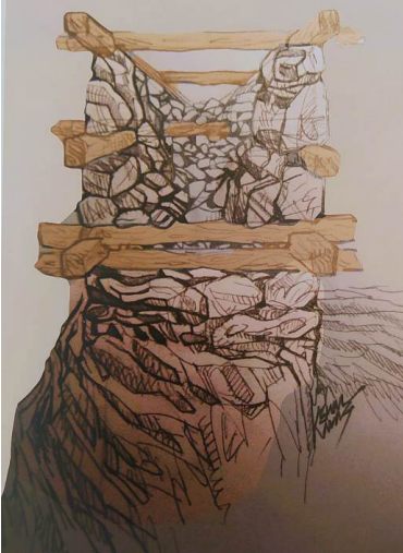
Çiz. 2-3: Geleneksel Düğmeli Duvarın Yapım Aşamasını Gösteren Kesit ve Görünüş (Kavas, 2016, 198, 170)
