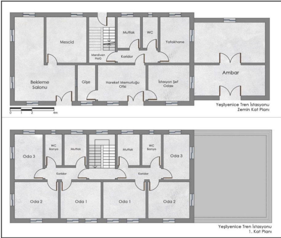
Çizim 4. Yeşilyenice tren istasyonu istasyon binası plan çizimi (2023)
