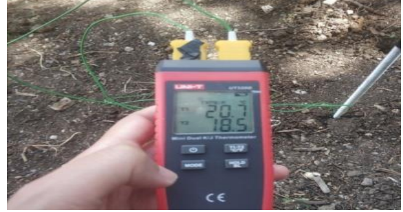
Figure 5. Figure of the thermometer measured the temperature of the earth (Toprak derinliğinden ölçüm alınan termometrenin örnek görüntüsü)
