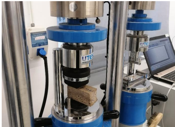
Şekil 3. Basınç ve eğilmede çekme deneyi, eğilme deneyi sonucu numuneler (Compressive and flexural tensile testing, appearance of specimens after flexural testing)
