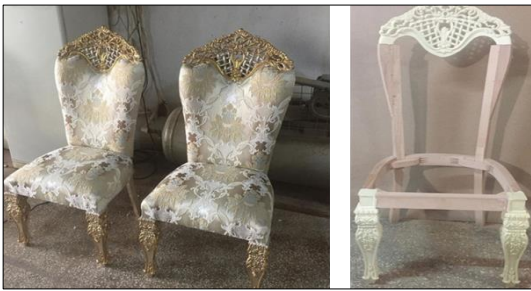
Resim 26. Poliüretan döküm ile üretilmiş döşemeli ve döşemesiz sandalyeler (Upholstered and non-upholstered chairs made of polyurethane casting)
