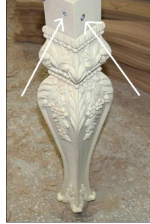
Resim 18. Poliüretan döküm ayağın montaj noktalarına civatalar yerleştirildiği örnek (Example where bolts are placed on the mounting points of the polyurethane cast foot)
