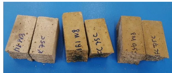
Şekil 3. Basınç ve eğilmede çekme deneyi, eğilme deneyi sonucu numuneler (Compressive and flexural tensile testing, appearance of specimens after flexural testing)
