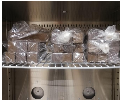
Şekil 2. Deney numuneleri (40mm*40mm*160mm) (Testing specimens (40mm*40mm*160mm))
