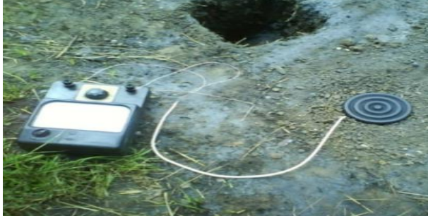
Figure 5. Figure of the thermometer measured the temperature of the earth (Toprak derinliğinden ölçüm alınan termometrenin örnek görüntüsü)
