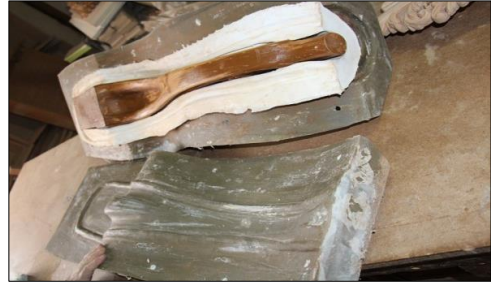
Resim 7. Silikon ile beyaz kalıp alındıktan sonra döküm örneği (Casting sample after removing white mold with silicone)
