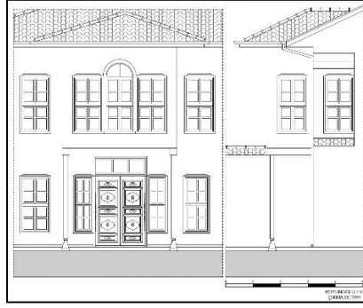
Görsel 18: Koyunoğlu evi çıkma ve giriş detayı (Yazar, 2023).
