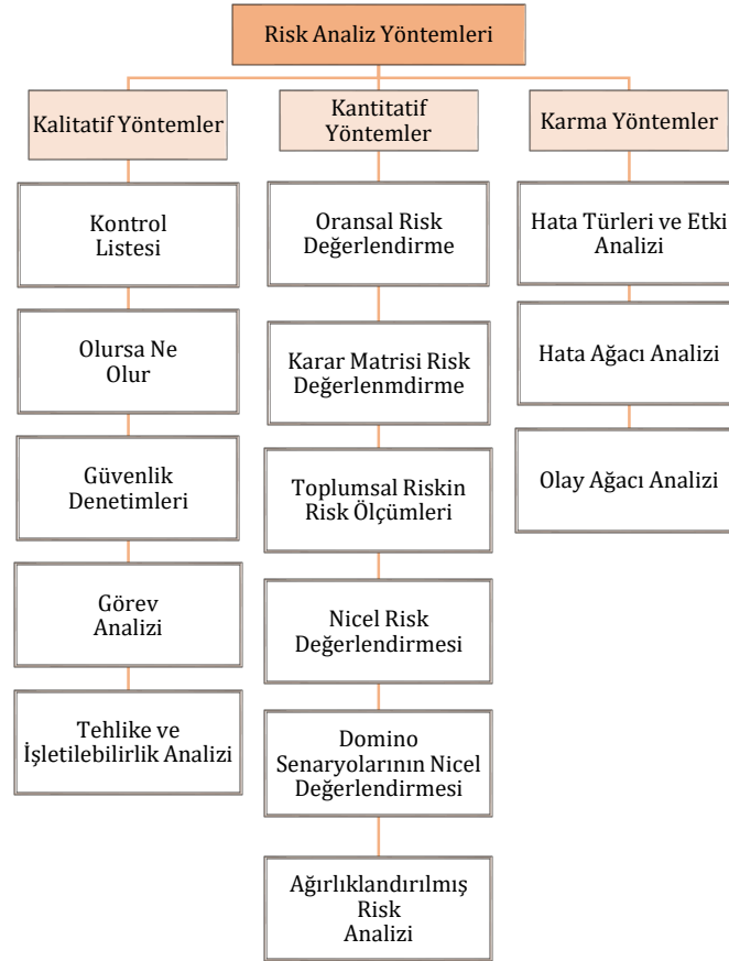
Şekil 1. Risk Analiz Yöntemlerinin Sınıflandırılması (Marhavilas vd., 2011)
