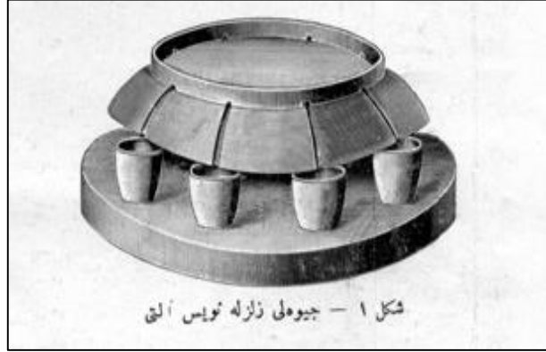
Şekil 3. Civalı Zelzele Nüvis Aleti (Civalı Deprem Yazıcı Alet) (Şehbal, 1325/1909).
