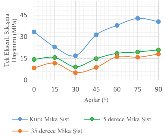
Şekil 8. Farklı sıcaklıklarda mika şist dayanımları
