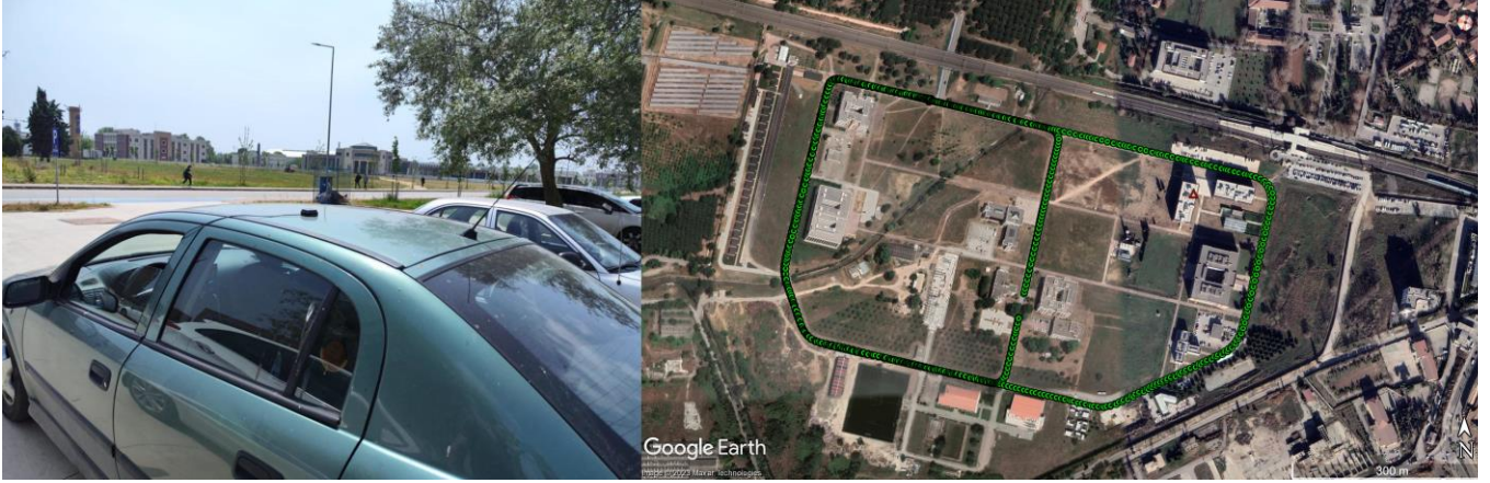
Şekil 3. Kinematik deney testinde kullanılan araç/düşük maliyetli GNSS anteni (sol) ve deney rotası (sağ)
