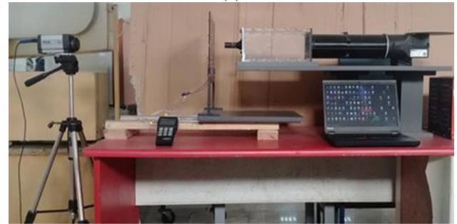
Şekil 1. Yatay eksenli çarpan jet akış düzeneği (a) Şematik görünüm (b) Fotoğraf görünüm
