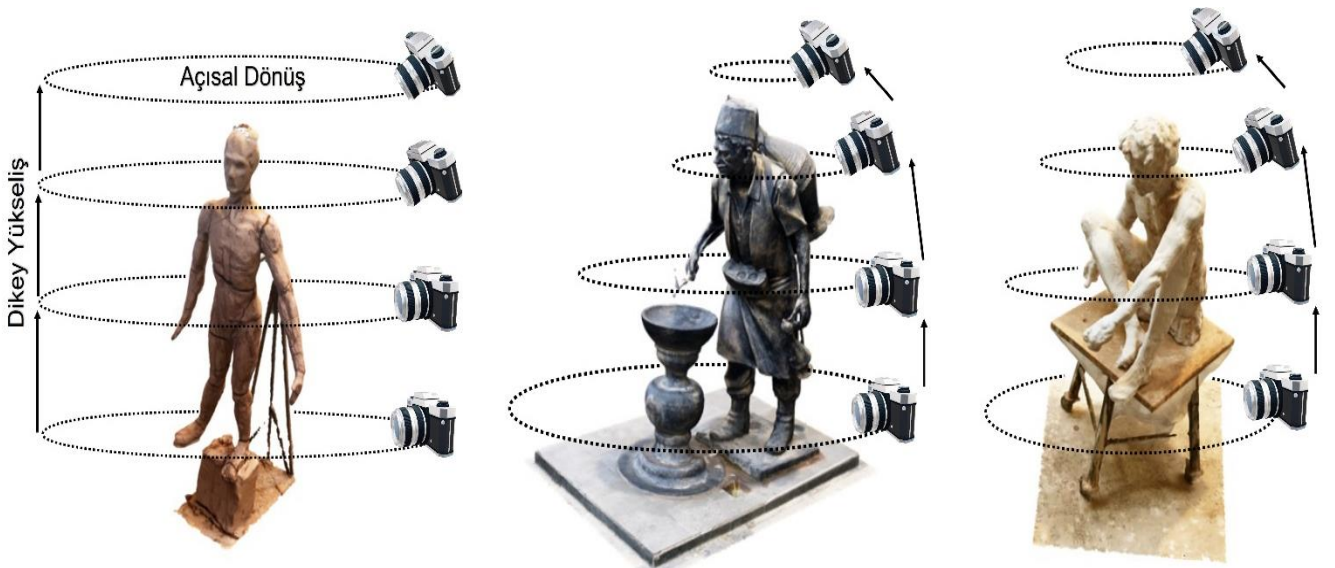
Şekil 2. Fotogrametri yöntemi için uygun fotoğraf çekim teknikleri
