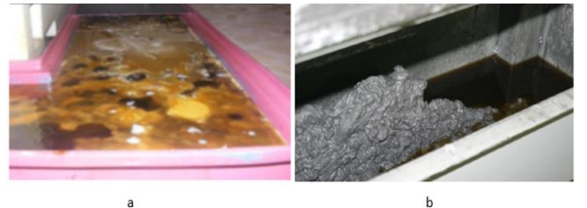
Şekil 3. Servis ömrünü dolmuş kesme sıvıları (a) bozulmuş kesme sıvısı [7] (b) Çamurlaşmış kesme sıvısı [23]
