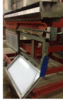
(c) Akışkanın aç-kapa mekanizmasıyla tahliye edilmesi
