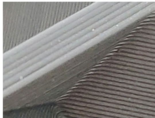
Şekil 3. 6 hat içeren numunenin kenarının (2,4 mm) yakından görünümü. 1 hat 0,4 mm genişliğindedir
