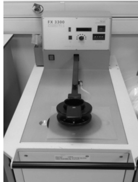
Şekil 4. Textest FX 3300 hava geçirgenlik test cihazı
