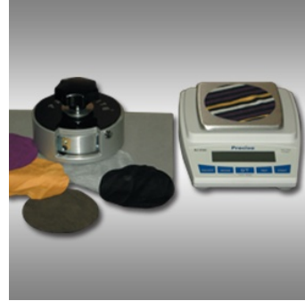
Şekil 3. Dairesel kumaş kesim cihazı, hassas terazi
