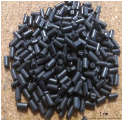
Şekil 2. Ti NP katkılı masterbatch cips [24]
