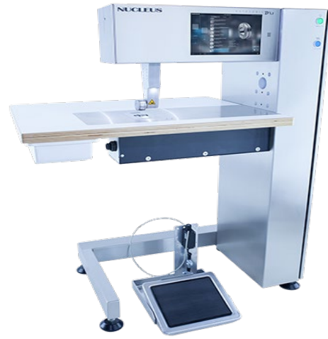
Şekil 1. Nucleus DX1 ultrasonik dikiş makinesi
