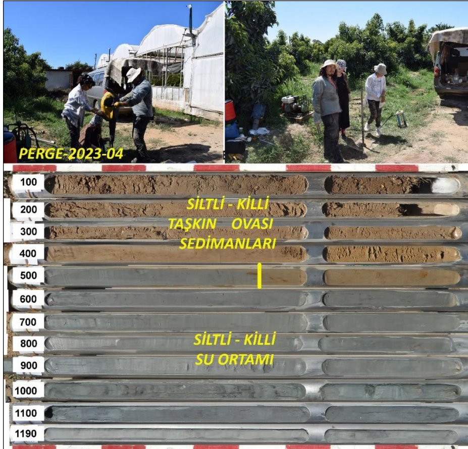
Şekil 8- PERGE-2023-04 (PRG-04) numaralı sondajın birikme ortamı özellikleri.
