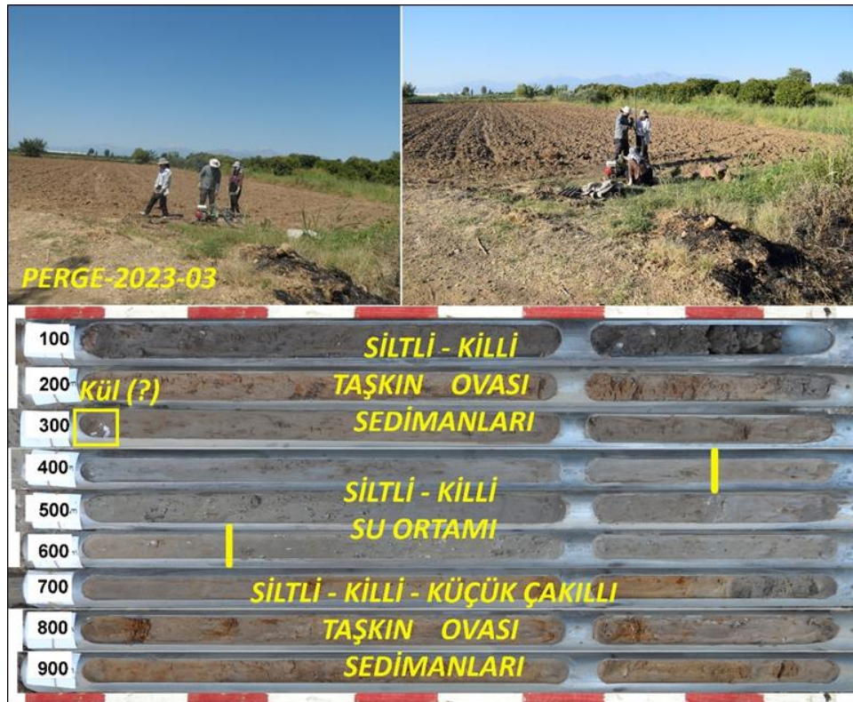
Şekil 7- PERGE-2023-03 (PRG-03) numaralı sondajın birikme ortamı özellikleri.
