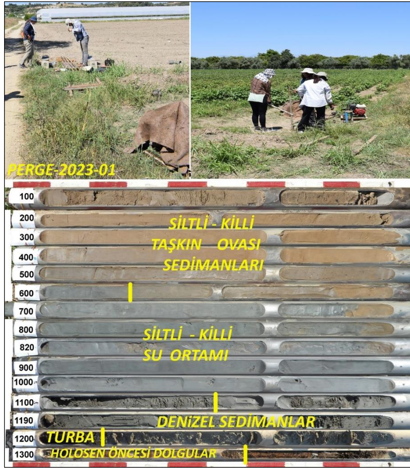
Şekil 5- PERGE-2023-01 (PRG-01) numaralı sondajın birikme ortamı özellikleri.
