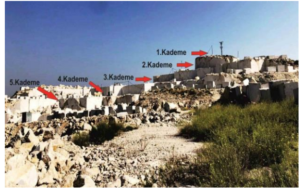
Şekil 5. Hacılar Kireçtaşı Ocağının kademeleri ve aynaların görünümü (Eğin Karaca 2019)
