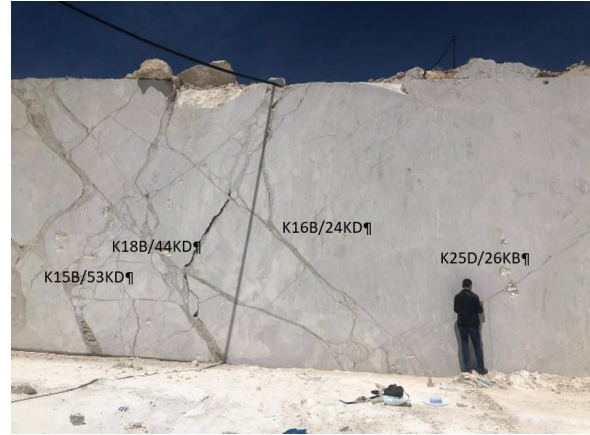
Şekil 6. Kademe 3'de gözlenen farklı yönlerde gelişen kil dolgulu çatlaklar, breşik yapıları kireçtaşları (Eğin Karaca 2019)
