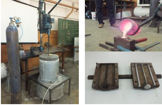
Şekil 1. Karıştırma Ünitesi ve Metal Kalıba Döküm
