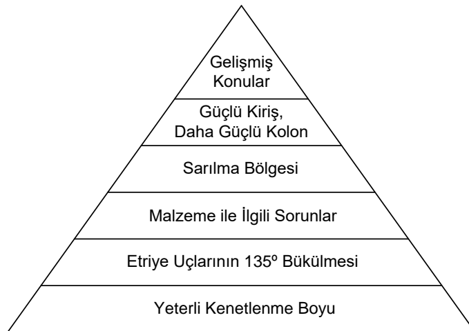
Şekil 3. Betonarme binalardaki sorunlar hiyerarşisinin üçgen olarak gösterimi
