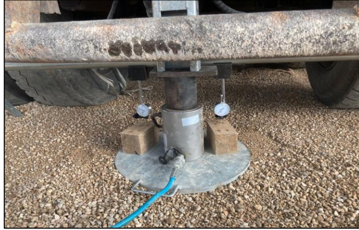
Şekil 6. Deney Sırasında Pistonun ve Deplasman Ölçerlerin Konumları
