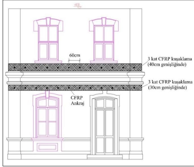
Şekil 4.3.4. CFRP kuşaklama (Figure 4.3.4. CFRP application)
