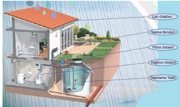
Şekil 1. Yağmur Suyu Hasadı (YSH) Sistemi (URL-1,2023)
