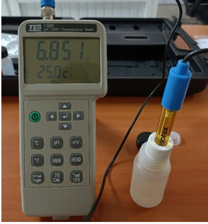
Şekil 14. Çözeltinin Ph değeri ölçümü
