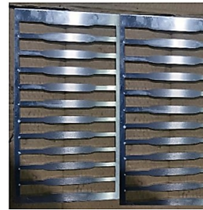
Şekil 3. Levhadan Çekme numunelerinin hazırlanması
