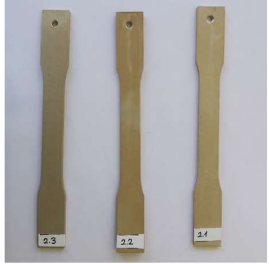
d) S170 Bilyesi 8A-12-15A korozyon testi sonrası
