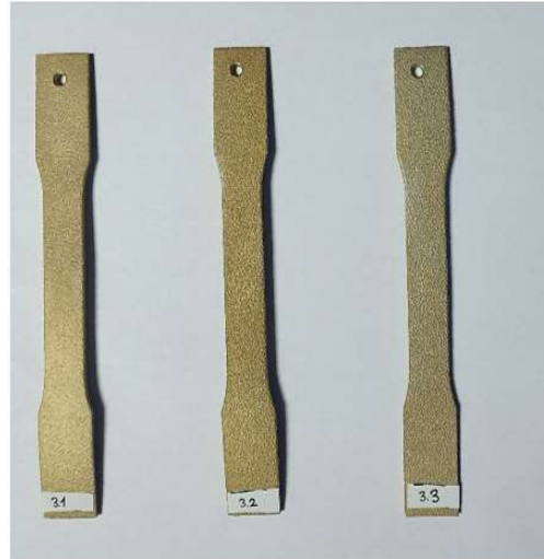
e) S230 Bilyesi 8A-12-15A korozyon testi öncesi
