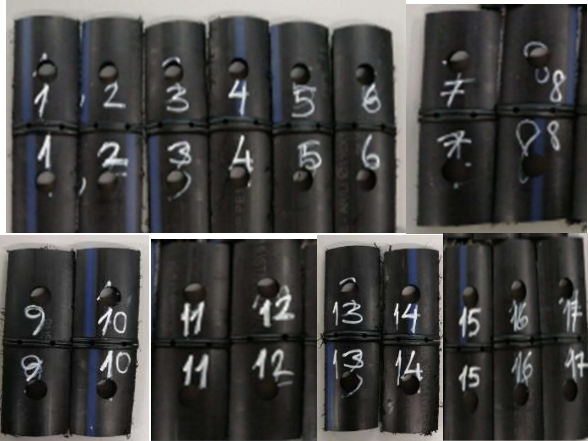
Şekil 5. Çekme testine tabi tutulacak numune görselleri
