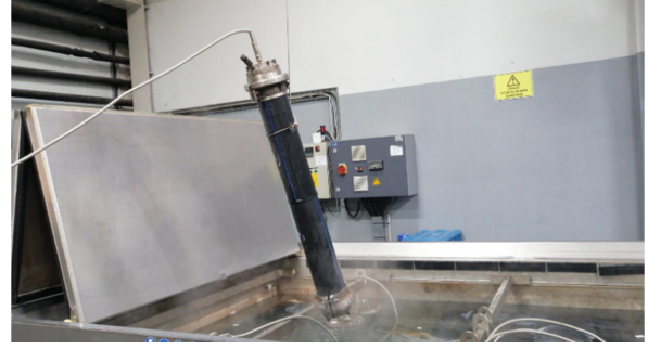
Şekil 7. Hidrostatik iç basınç testi sonrası numune görseli
